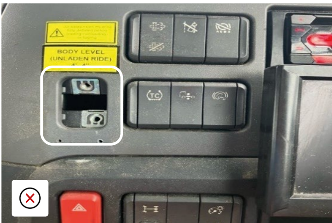
Schroefgaten in dashboard en bekleding ontbreken
