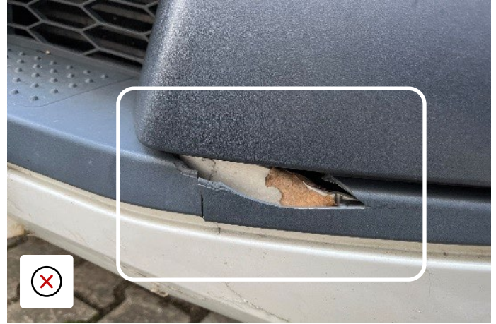
Grote schade bumper moet hersteld worden
