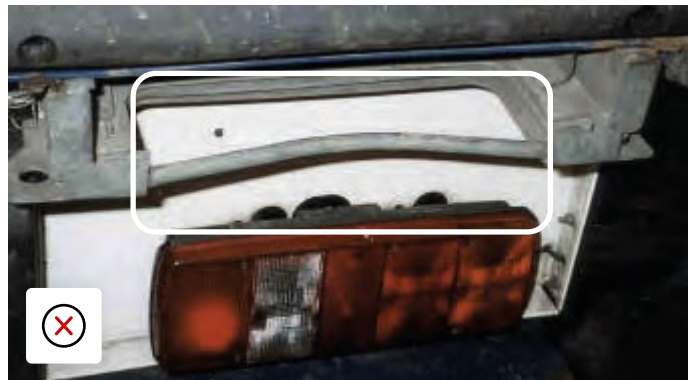
Achterste toegangsladder is beschadigd geretourneerd.
