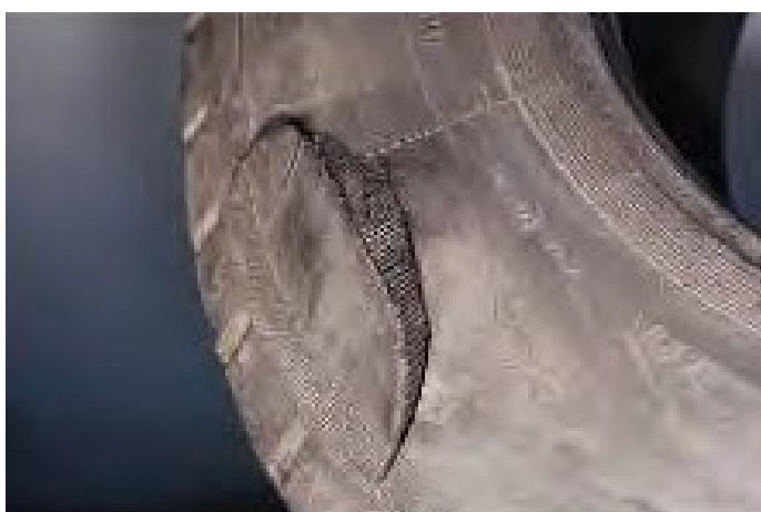
Uitval door separatie gordel-/karkaslagen
