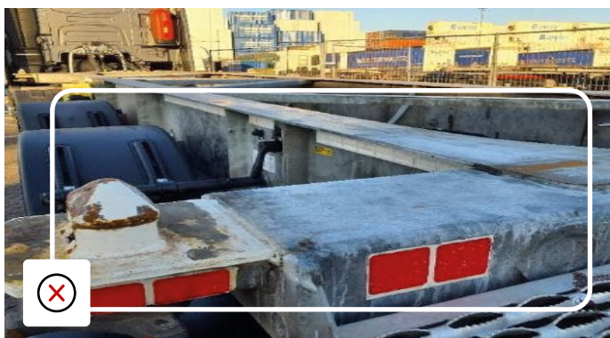
Chassis vervuild met schadelijke stoffen dat specialistische reiniging vereist
