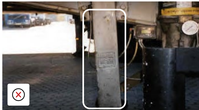
Verbogen steunpoot: aan de klant worden geen kosten doorberekend indien het verschil niet meer dan 10% van de 90-graden hoek bedraagt. Aan de klant worden wel kosten in rekening gebracht indien de genoemde limiet wordt overschreden of indien de steunpoot niet meer naar behoren functioneert.
