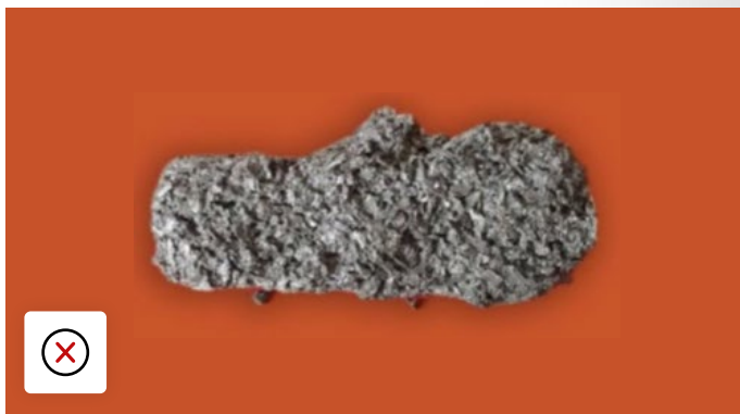
TPMS-sensor vervuild door afdichtmiddel
