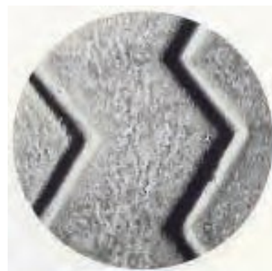
Olifantenhuid of scheurvorming door te krap of vanuit stilstand manoeuvreren
