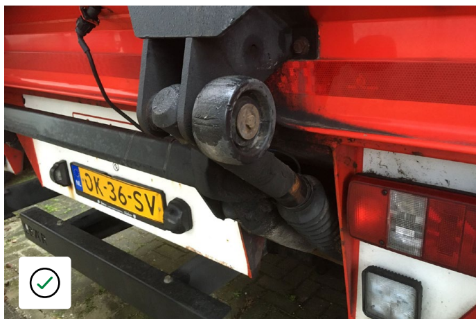
Platformrol met lichte slijtage
