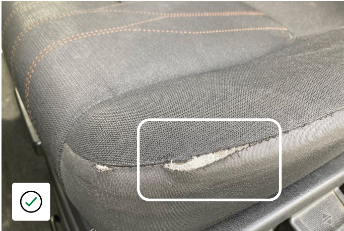
Kleine slijtageplekken op de stoelbekleding door normaal gebruik
