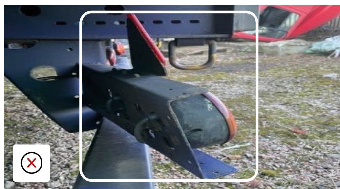
Achterlichtbak verbogen en reparatie vereist
