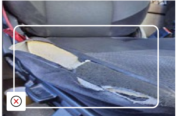
Scheuren in stoelbekleding waardoor schuimvulling zichtbaar wordt
