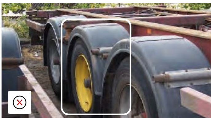
Wiel van verkeerde kleur en spatborden waarop patches zijn aangebracht. De schade is mogelijk het gevolg van te zware belasting of rijden met verkeerde rijhoogte.
