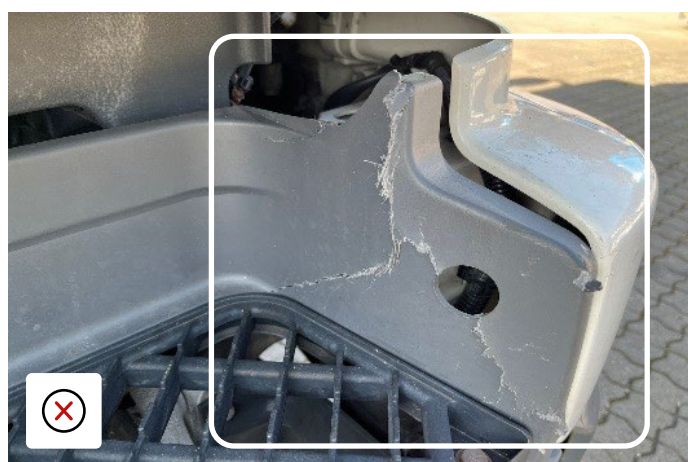
Opstapbak onveilig door botsing
