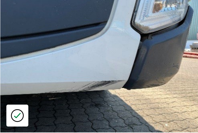
Kleine schade - acceptabel
