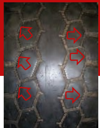
Scheuren in het loopvlak door overspanning.
