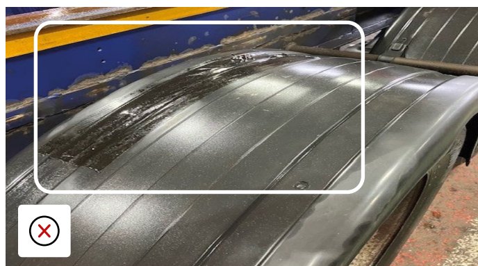
Gerepareerd spat scherm moet worden vervangen
