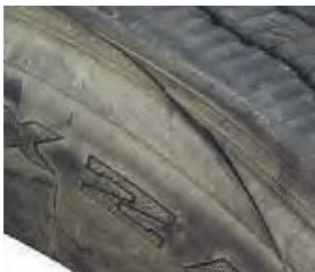
Inrijdingen in loopvlak, schouder en zijwand beschadigingen door overspanning
