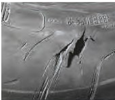
Diepe zijwand beschadigingen
