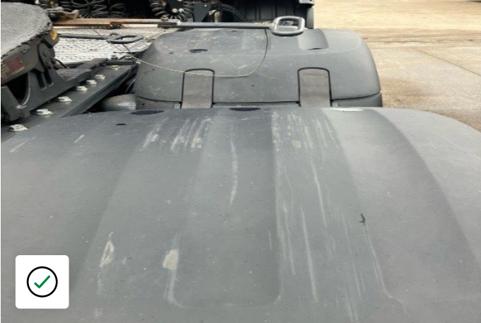
Kleine slijtageplekken aan afneembare wielkap achterwiel - acceptabel
