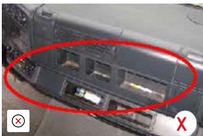
Mancano i coperchi di copertura
