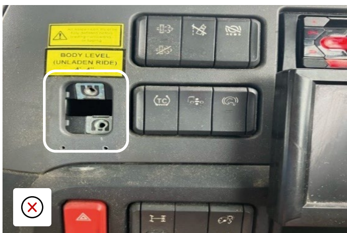
Fori delle viti nel cruscotto e finiture mancanti
