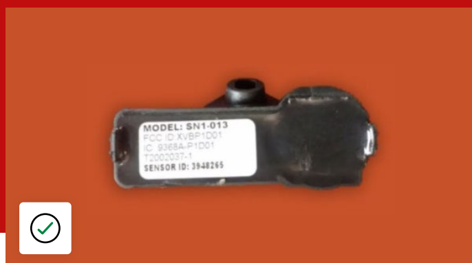
Sensore TPMS in condizioni accettabili
