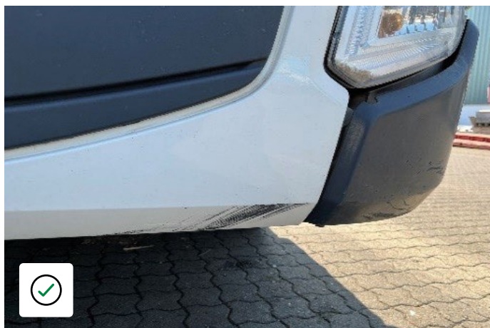
Graffio minore - nessun danno alla struttura
