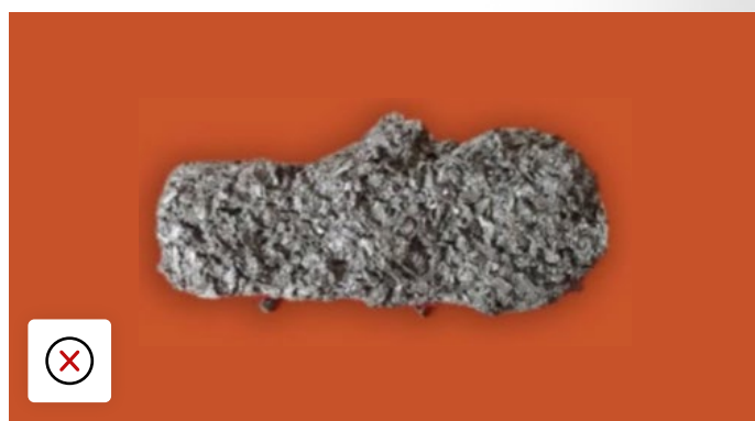
Sensore TPMS contaminato dal sigillante
