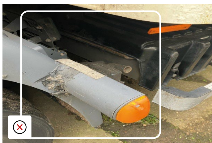
Riparazione non conforme al montaggio del ripetitore laterale
