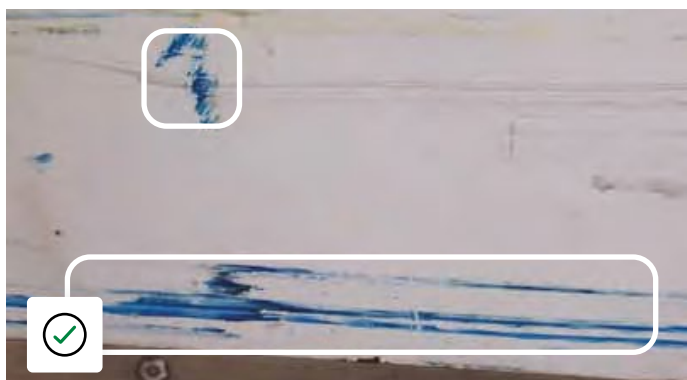
Pannelli in GRP graffiati dai pallet, ma senza che tali graffi raggiungano lo stato di resina.
