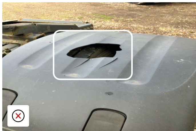
Parte superiore del parafrangente bucata
