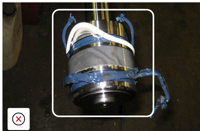
Raccordi idraulici danneggiati da uso improprio e urti
