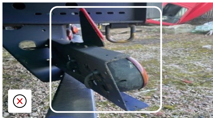
Braccio della lampada piegato e da riparare
