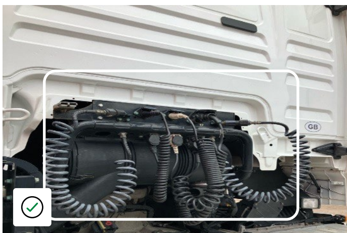
Tubazioni e giunti di accoppiamento in buone condizioni e correttamente conservati
