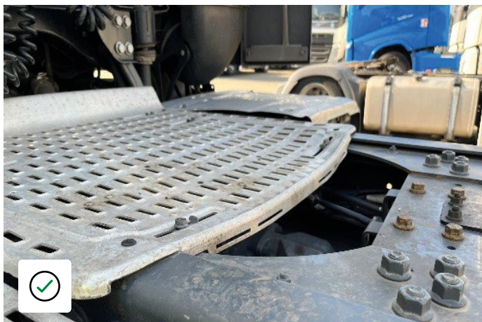
Deformazioni minori dovute alla normale usura
