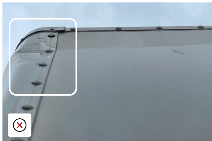
Montanti angolari danneggiati da urti con rimozione della vernice superficiale.
