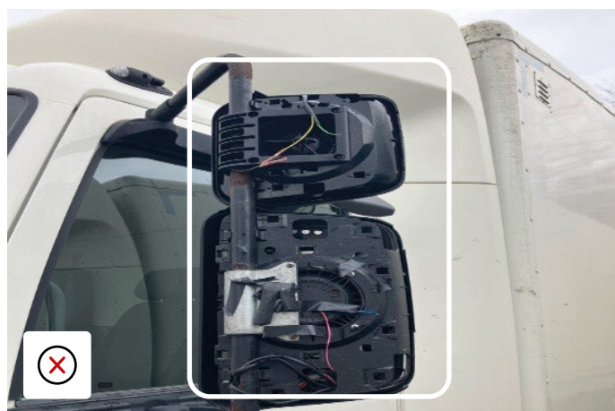
Manca completamente la copertura dello specchietto
