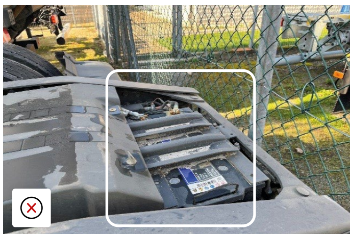
Coperchio della batteria mancante, che espone la batteria alle intemperie
