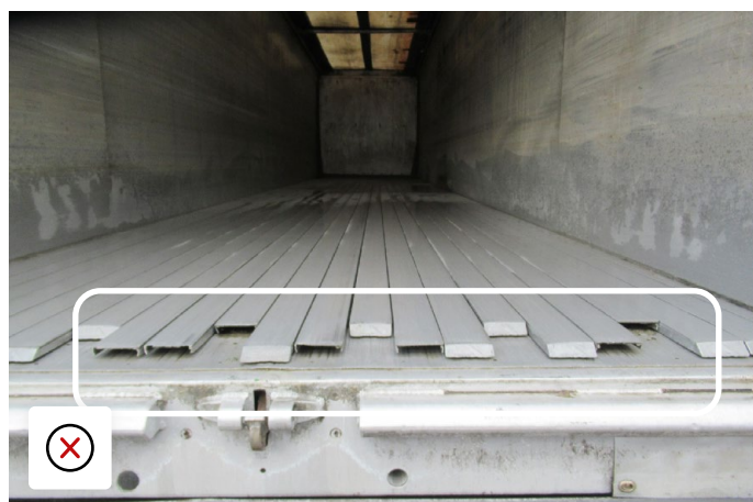
Mancano i bordi delle barre - la merce può cadere sotto il pavimento
