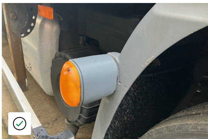
Ripetitore laterale e montaggio in condizioni accettabili
