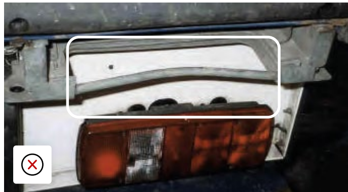
Scala per l'accesso sul retro restituita danneggiata.
