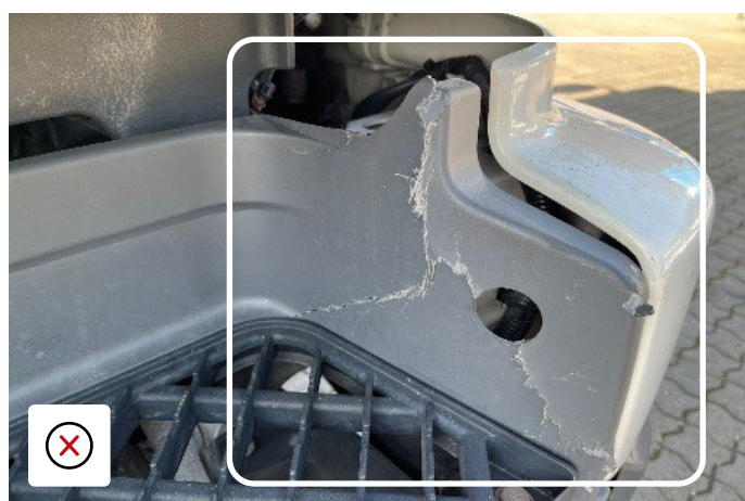
Struttura di supporto del gradino non sicura a causa dell'impatto
