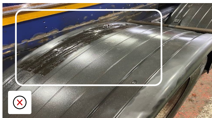
Il parafrangente rattoppato richiede la sostituzione
