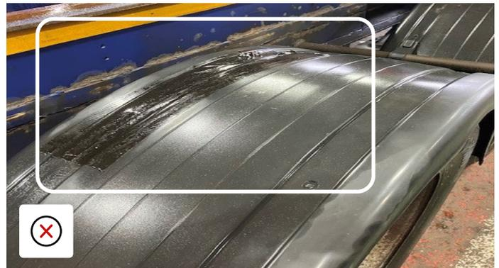
Kotflügelabdeckung muss ersetzt werden
