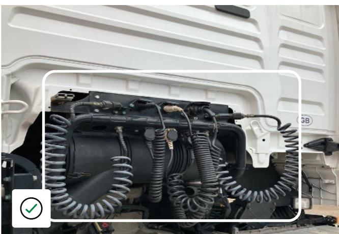
Druckluftschläuche in gutem Zustand & korrekt gelagert
