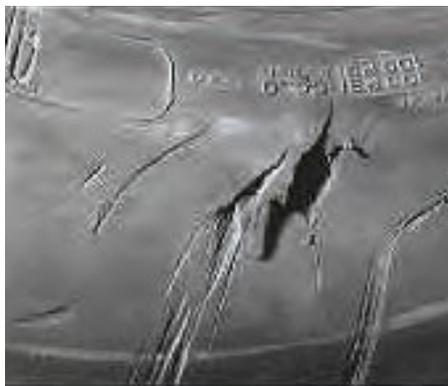
Tiefes Eindringen in die Seitenwand Beschädigung des Reifens.
