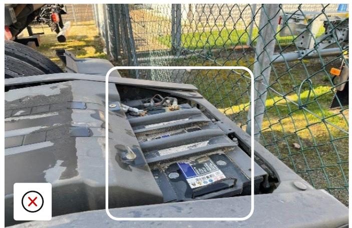
Die Batterieabdeckung fehlt - die Batterie ist den Elementen ausgesetzt
