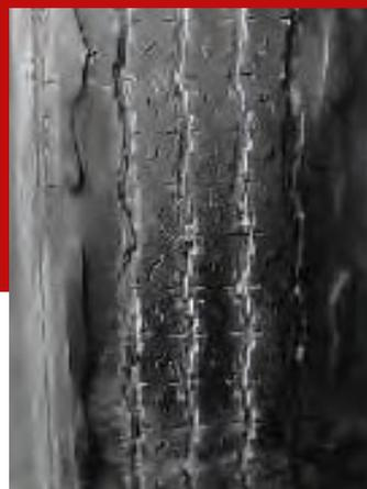
Verschleiß aufgrund von Ausrichtungsproblem
