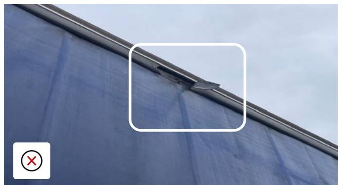
Gummidichtung der Seitenplane nach Aufprall gerissen - lässt Wasser eindringen
