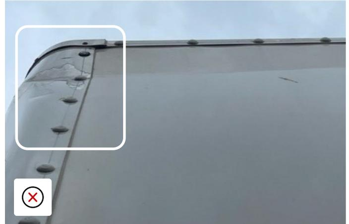
Beschädigte Eckpfosten, deren Farbe fehlt.
