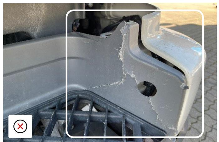
Stufentragwerk durch Aufprall unsicher
