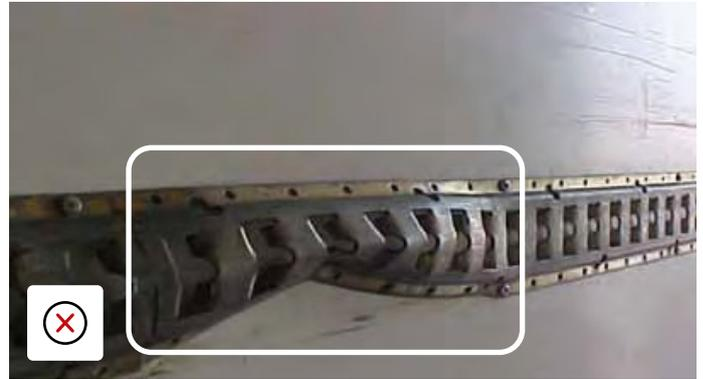
Innere Ladungssicherung, welche so stark beschädigt wurde, dass man es nicht mehr reparieren kann.
