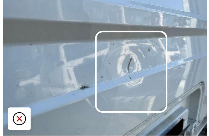
Aufprallschaden an der Rückseite des Fahrerhauses mit Rissbildung
