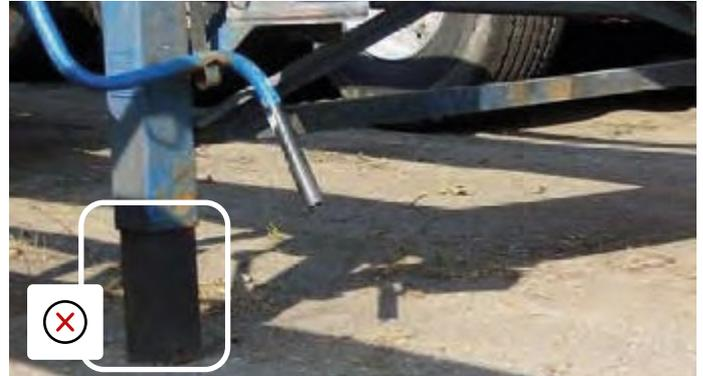
Ein Schaden am Stützbeinfuß wird, wenn dieser nicht ersetzt wird, zu Schäden am Stützbein-Inneren führen.
