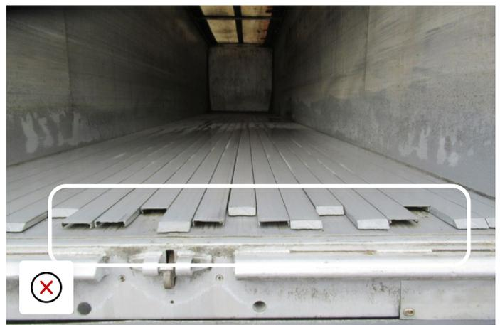
Spreizung der Bodenleisten und unsicherer Transport - Waren können durch den Boden fallen
