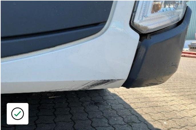
Leichte Schramme - keine Beschädigung der Struktur
