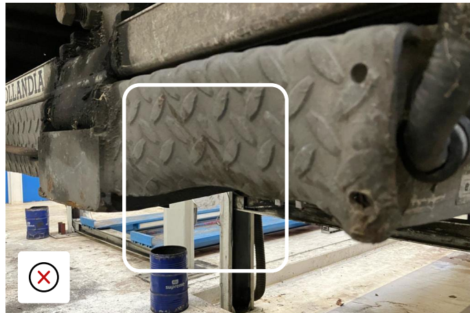
Náraz do plošiny v kritickém úseku - vyžaduje opravu
