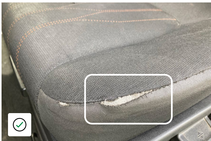
Drobné oděrky na potahu sedadla způsobené běžným používáním
