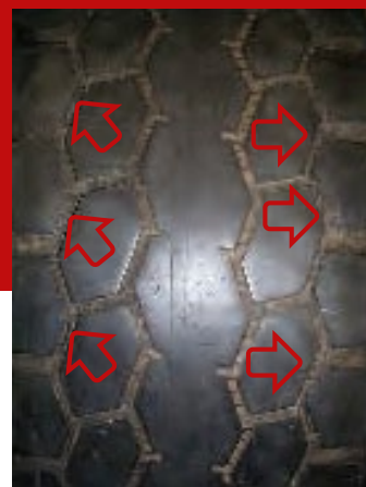
Praskliny v dezénu běhounu v důsledku přehuštění
