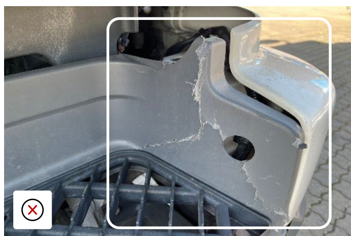
Nosná konstrukce schůdků je v důsledku nárazu nebezpečná
