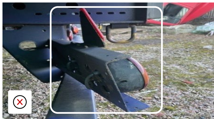
Ohnuté rameno světla a nutná oprava
