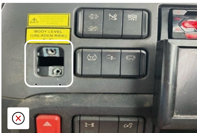
Chybějící ovladače a tlačítka a díry v přístrojové desce a obložení
