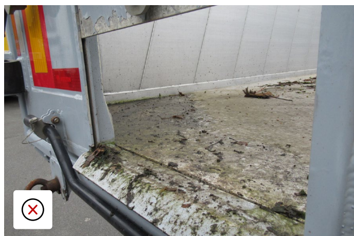
Podlaha vyžadující čištění
