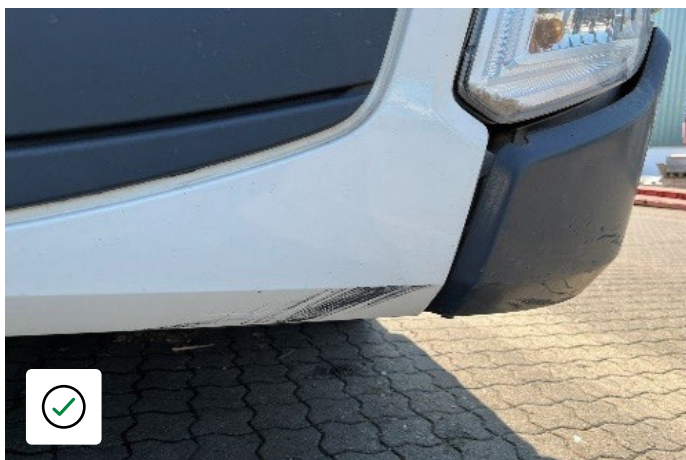
Drobný škrábanec - bez poškození konstrukce
