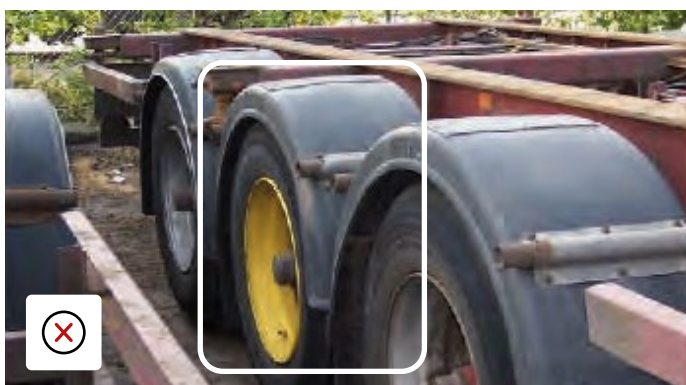
Špatná barva kola a zaplátované blatníky, poškození pravděpodobně způsobené nadměrným zatížením nebo jízdou ve špatné výšce.
