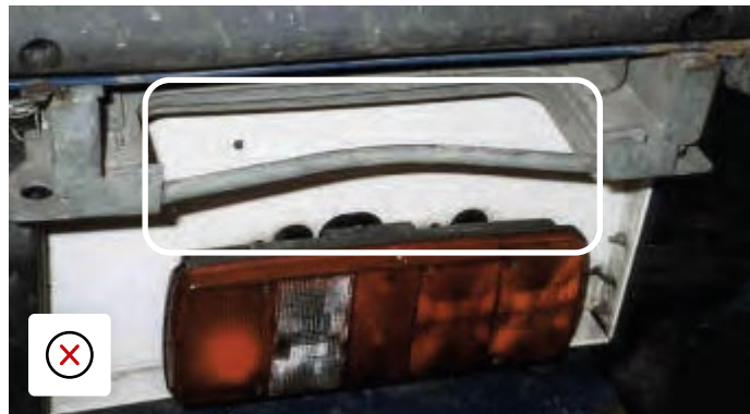
Zadní přístupový žebřík vrácen s poškozením.
