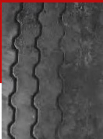
Nerovnoměrné opotřebení v důsledku špatného seřízení nebo vybočení
