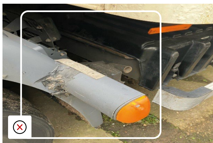
Substandardní oprava upevnění bočního blinkru
