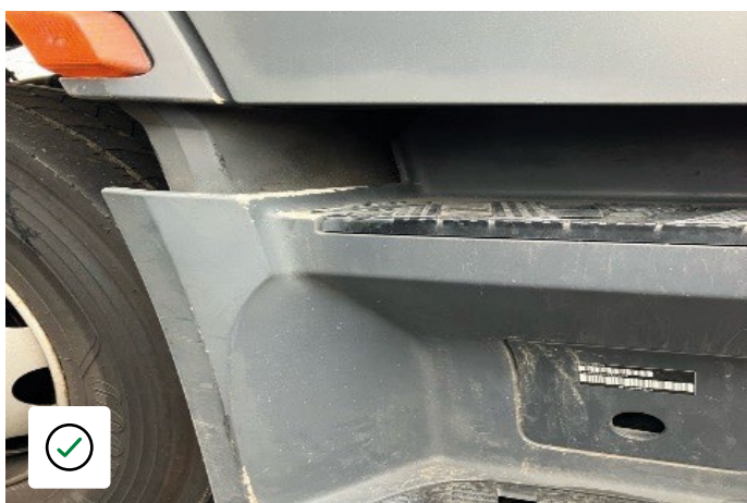
Lehké oděrky bez poškození schůdku
