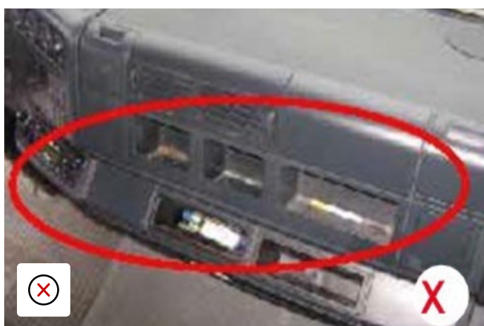
Chybějící zaslepovací kryty
