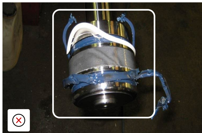
Hydraulické armatury s poškozením v důsledku nesprávného použití a nárazu
