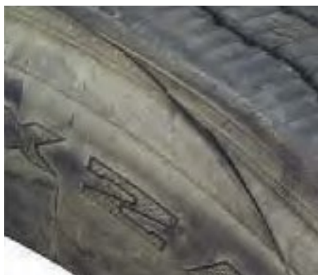
Hluboké proražení pneumatiky, poškození ramene a bočnice.
