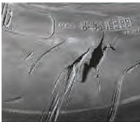
Hluboké poškození bočnice pneumatiky
