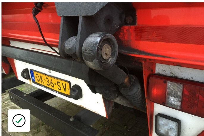
Válec plošiny s drobným opotřebením
