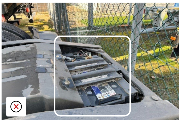
Chybějící kryt baterie - vystavení baterie povětrnostním vlivům
