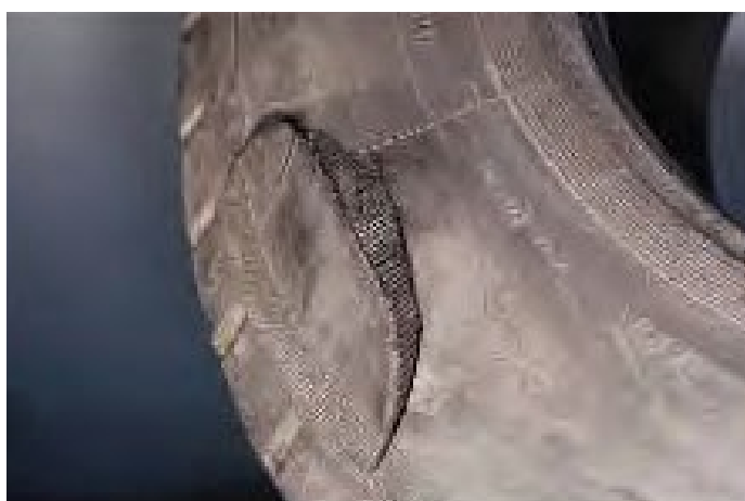
Vyboulení boční stěny v důsledku proražení vnitřního lemu.
