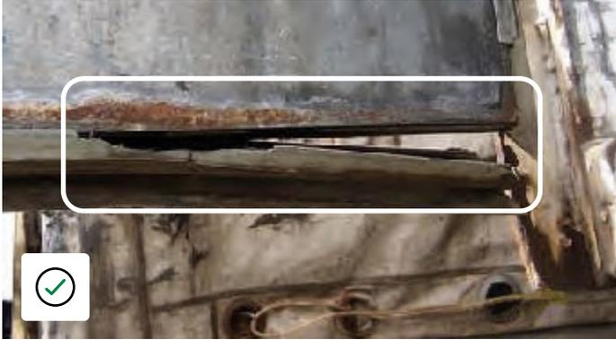
Puerta antigua con corrosión en la superficie interior. Daños en las juntas debido a un uso continuado que no provoca deformación en el panel de la puerta.
