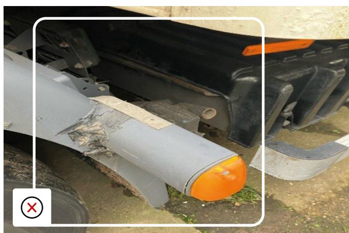
Reparación deficiente del soporte del repetidor lateral
