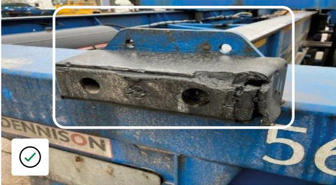
Uso Normal de la goma protectora de la llanta. No se cargará al cliente siempre y cuando no dañe el área del remolque que debe proteger el paragolpes.
