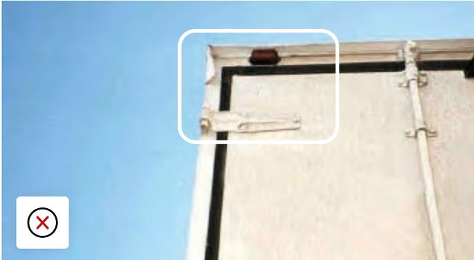
Compensadores de protección de agua del bastidor de la puerta trasera doblados debido a un impacto.
