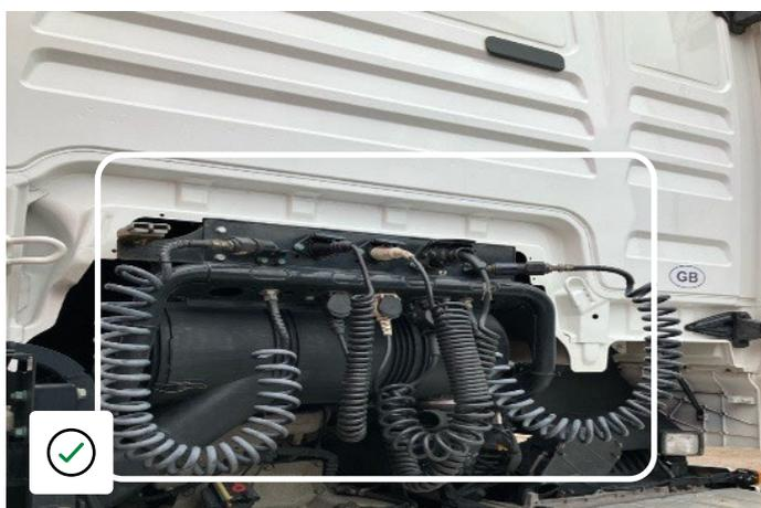
Acoplamiento de las mangueras de aire en buen estado y almacenados correctamente
