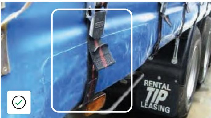
Reparación correcta del borde inferior exterior con esquinas redondeadas para evitar que se arranque.
