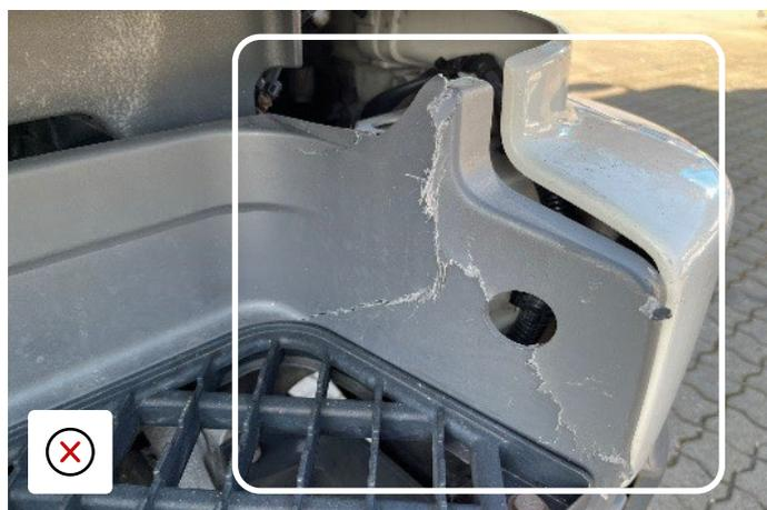
Estructura de soporte del escalón insegura debido al impacto
