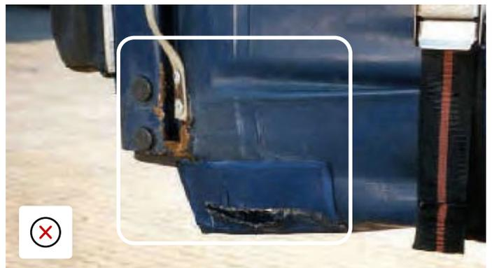
Cortes no reparados en el material de la cortina a la altura del borde inferior.
