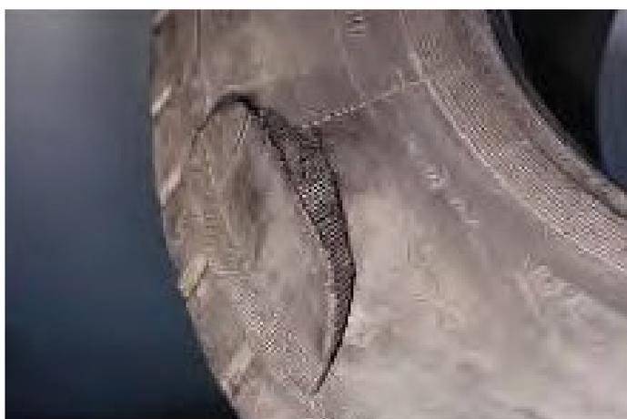
Reventón de la pared lateral debido a la penetración de la línea interior.
