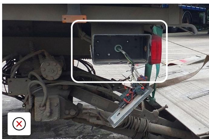
Interruptor externo roto - requiere sustitución
