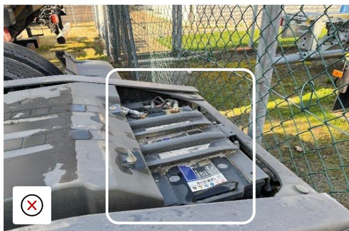
Falta la tapa de la batería, que queda expuesta a la intemperie
