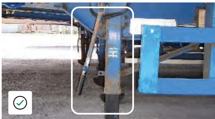
Pata de sujeción derecha con manija de seguridad.
