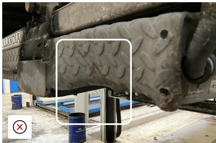
Plataforma impactada en una sección crítica - requiere reparación
