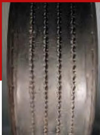
Desgaste rápido del hombro debido a un inflado insuficiente
