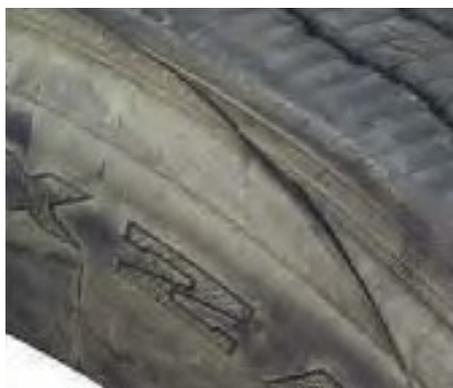
Penetración profunda en el neumático, daños y daños en los flancos.
