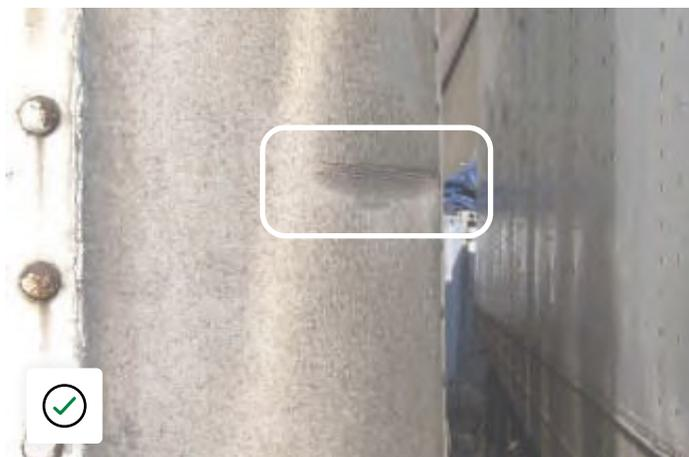
Poste de esquina dañado por un impacto. Abollado pero no perforado.
