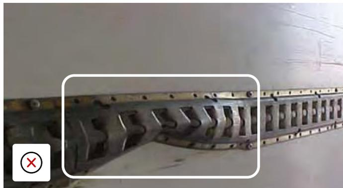
Guía sujetacargas dañado sin reparación posible.
