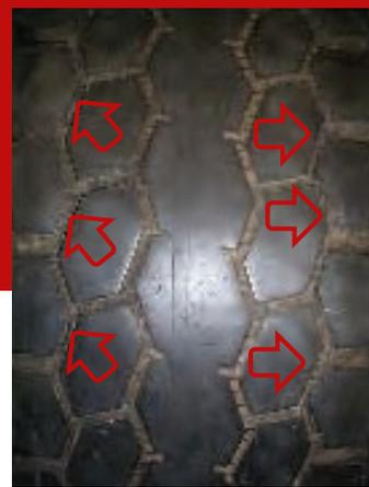
Grietas en la banda de rodadura debido a un inflado excesivo
