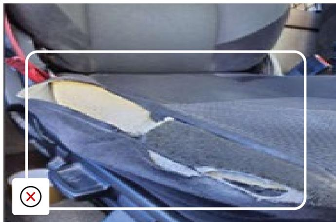
Rasgaduras en la funda del asiento que dejan al descubierto el relleno de espuma
