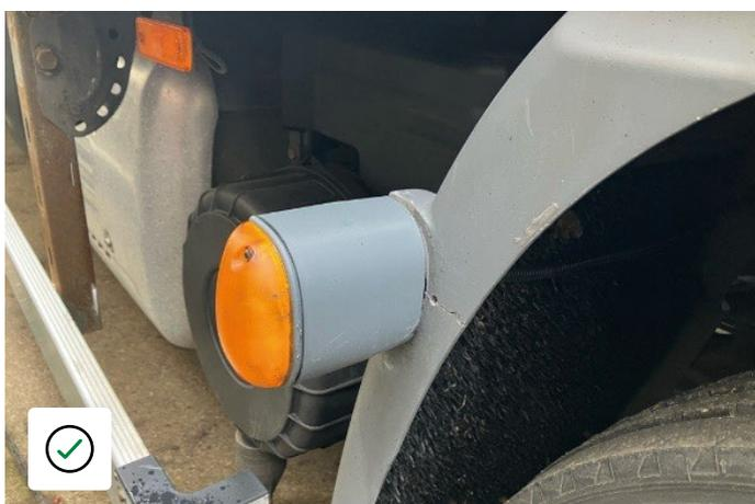
Repetidor lateral y montaje en condiciones aceptables
