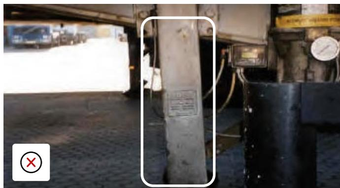
Pata de sujeción doblada y necesita ser reemplazada
