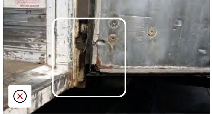
Puerta antigua con corrosión en la superficie interior. Impacto en la esquina que ha dañado el panel de la puerta y las juntas hasta un extremo tal, que no se pueden instalar juntas nuevas.
