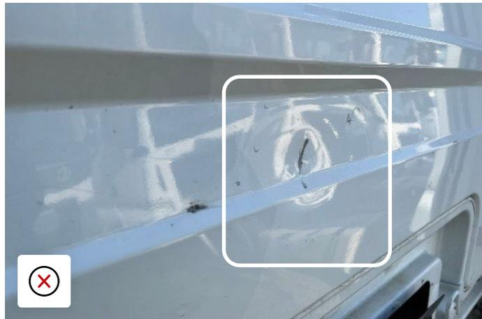
Daños por impacto en la parte trasera de la cabina causando una grieta
