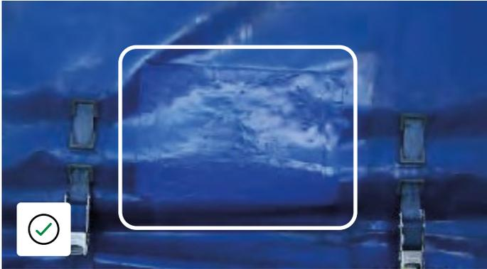
Reparación correcta de la lona exterior con esquinas redondeadas para evitar que se arranque.
