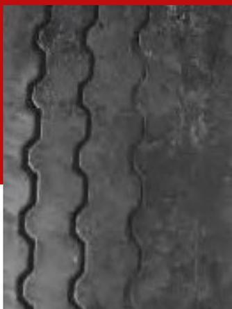
Desgaste irregular debido a desalineación o inclinación
