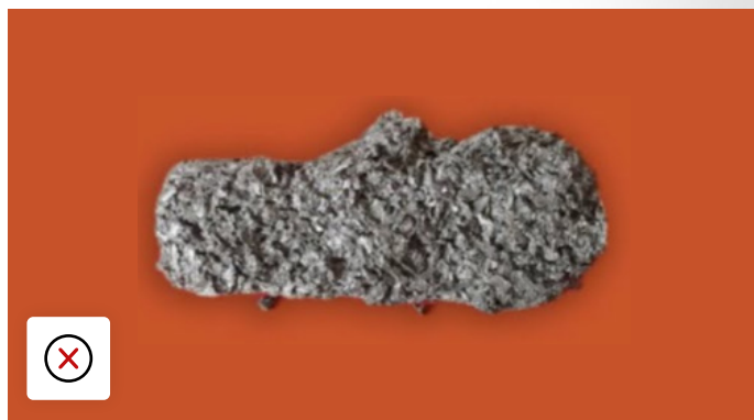
Czujnik TPMS zanieczyszczony przez uszczelniacz
