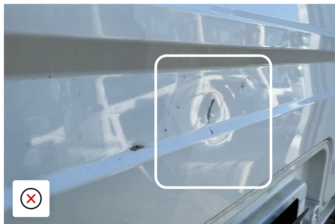
Uderzenie w tył kabiny powodujące pęknięcie
