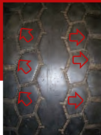
Pęknięcie rowków bieżnika z powodu nadmiernego ciśnienia
