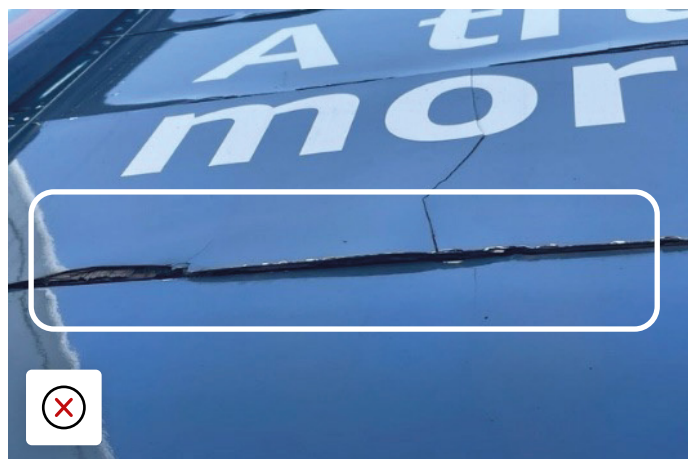
Panel drzwi rolety pękł w wyniku uderzenia
