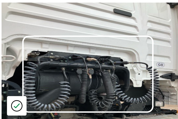
Przewody przyłączeniowe w dobrym stanie i prawidłowo przechowywane
