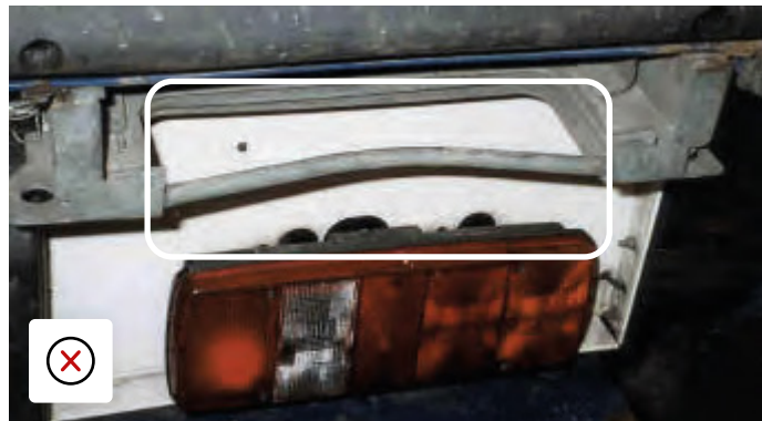
Tylna drabina dostępowa zwrócona z uszkodzeniami.
