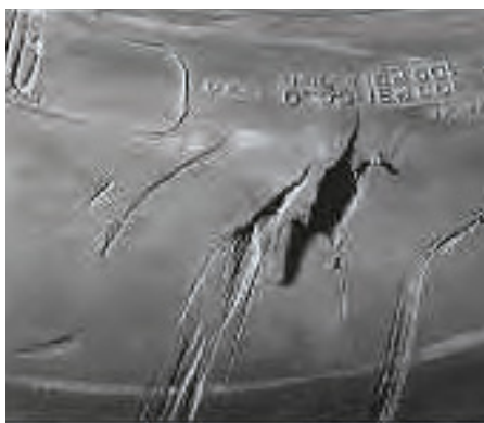
Głęboko uszkodzenie ściany bocznej opony.
