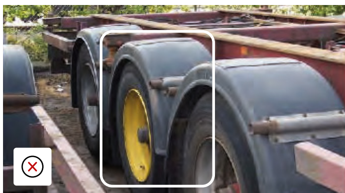
Nieprawidłowy kolor kół i łatane błotniki, uszkodzenia prawdopodobnie spowodowane przeciążeniem lub jazdą na niewłaściwej wysokości.
