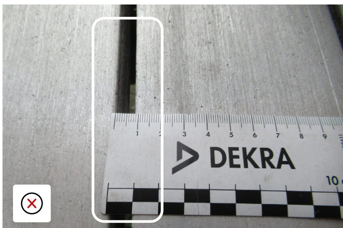
Pręty podłogowe rozchodzą się i nie są bezpieczne w transporcie - towary mogą wypaść przez podłogę.
