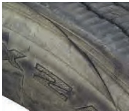
Głębokie przebicie opony, uszkodzenie grzbietu i ściany bocznej.
