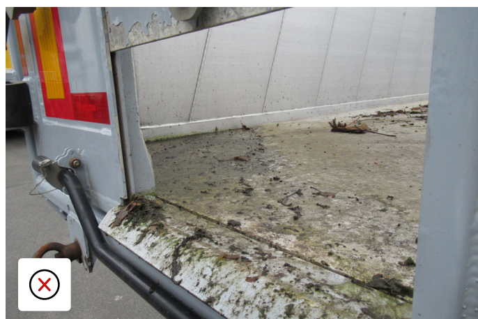
Podłoga wymagająca czyszczenia
