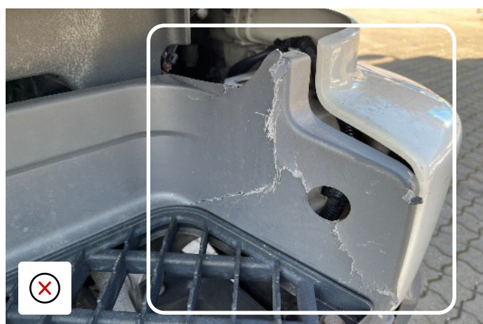
Konstrukcja wspierająca stopień jest niebezpieczna z powodu uderzenia
