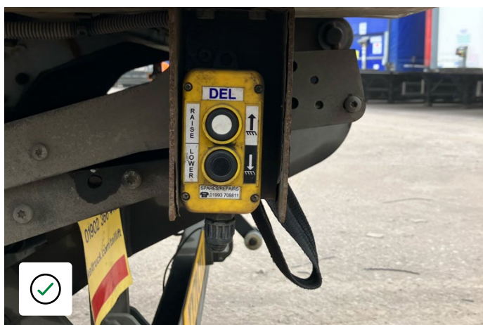
Comutator extern prezent și operațional
