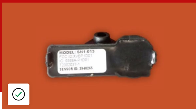
Senzorul TPMS în stare acceptabilă
