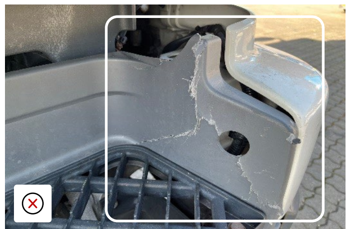
Structura de susținere a treptelor este nesigură din cauza impactului
