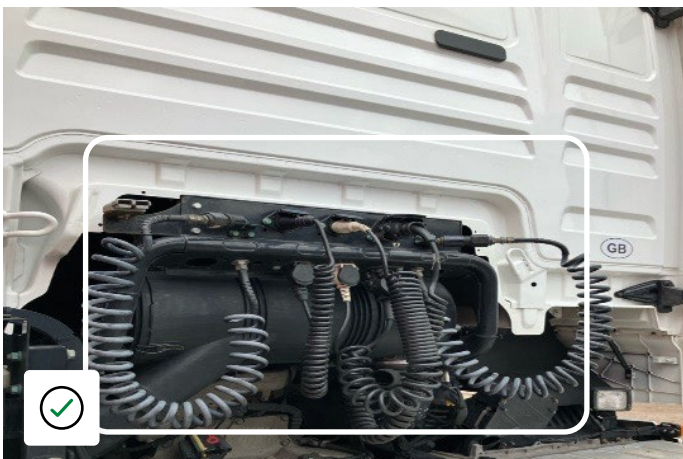
Cuplaje Suzie în stare bună și depozitate corect
