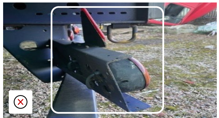
Brațul lămpii este îndoit și necesită reparații
