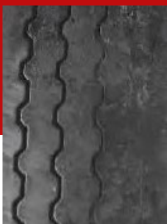
Uzură inegală din cauza nealinierei sau al unghiului de cădere
