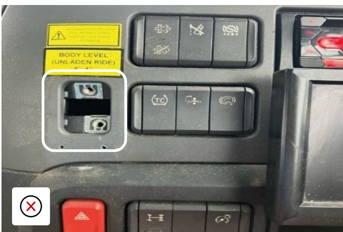
Găuri pentru șuruburi în bord și ornamente lipsă
