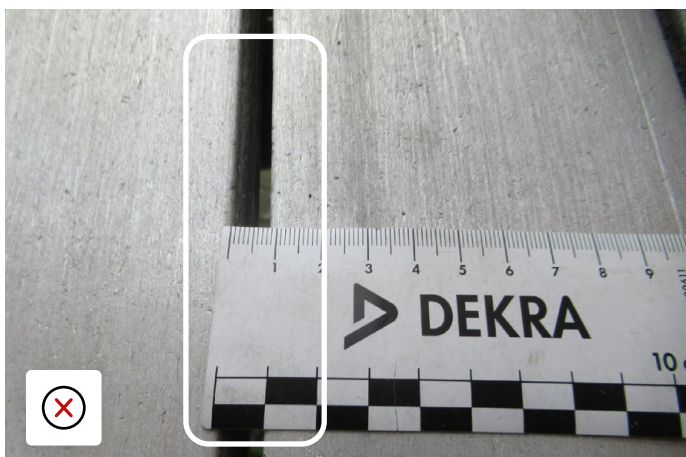
Barele podelei sunt împrăștiate și nu sunt sigure pentru transport - mărfurile pot cădea prin podea
