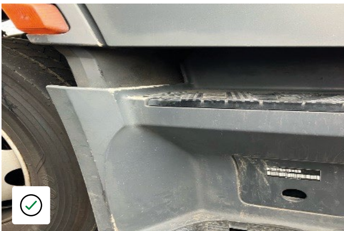
Zgârâieturi ușoare și nicio deteriorare la treaptă
