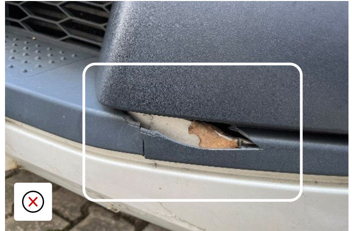
Impact major - bara de protecție nu este adecvată scopului
