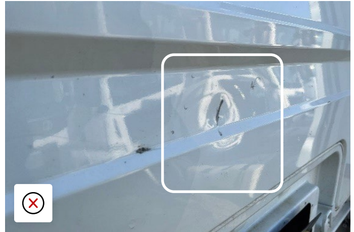
Daune provocate de impact în partea din spate a cabinei care au provocat fisuri
