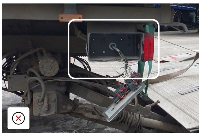
Comutator extern spart - necesită înlocuire
