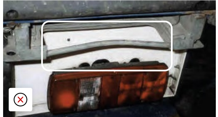
Scara de acces din spate a fost returnată cu deteriorări.
