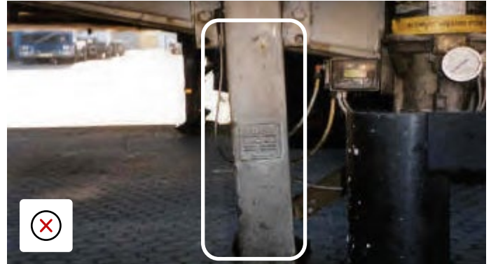
Piciorul de sprijin este îndoit și trebuie să fie înlocuit
