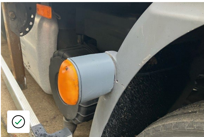
Repetitor lateral și montare în stare acceptabilă
