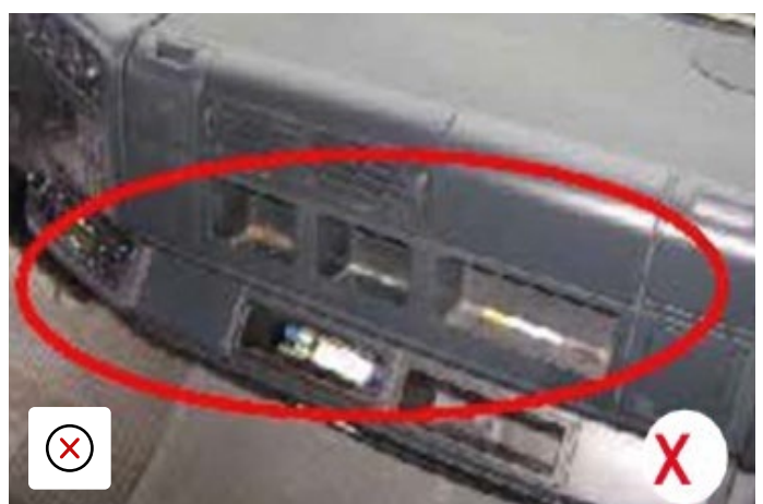
Copertinele de protecție lipsă
