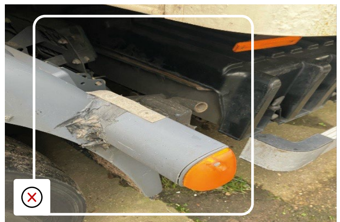
Reparații necorespunzătoare la montarea repetoarelor laterale
