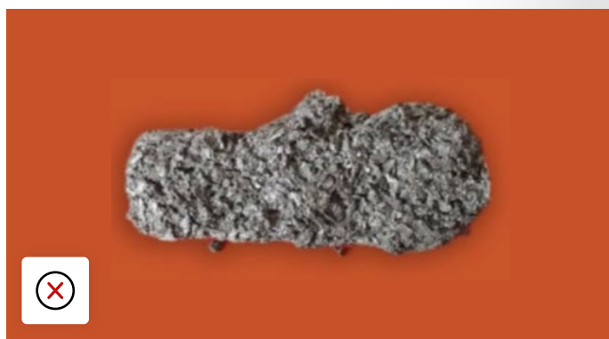
Senzorul TPMS contaminat cu material de etanșare
