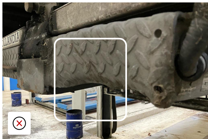
Platformă lovită la o secțiune critică - necesită reparații
