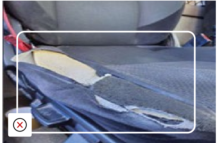
Rupturi la capacul scaunului, expunând umplutura de spumă
