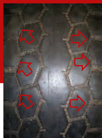
Fisurarea canelurii benzii de rulare din cauza presiunii excesive
