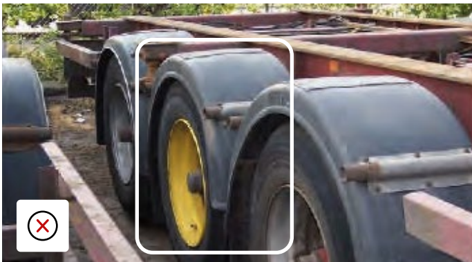
Roată de culoare greșită și aripi peticite, deteriorări cauzate probabil de supraîncărcare sau de rularea la o înălțime greșită.
