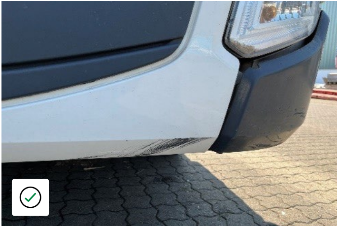
Zgârietură minoră - nicio deteriorare a structurii
